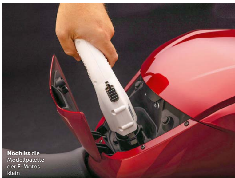
Zero SR/F Roadster Motor: max. 82 kW / 190 Nm Batterie: 14,4 kWh Gewicht: 220–226 kg Preis: ab 21 990 Fr.
