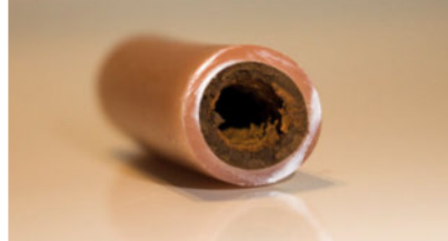
Versprödetes und verschlammtes Bodenheizungsrohr.
