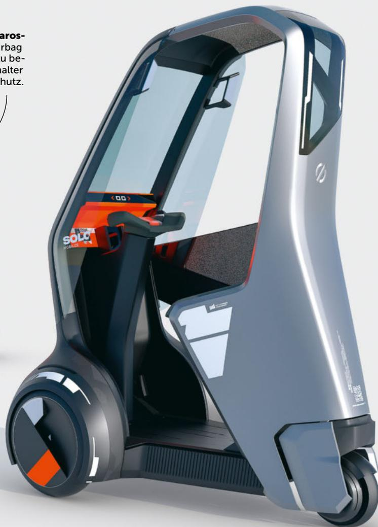
**Die Lenkung** erfolgt über das Hinterrad, der Antrieb über die Vorderräder. Dirigiert wird per Joystick. Unter dem Sitz befindet sich zudem Stauraum für Gepäck oder Einkäufe.
