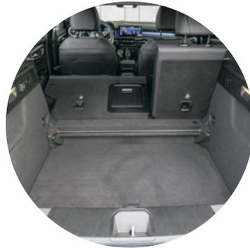
**Der entfernbare Boden** erlaubt es, die gute Kapazität des Kofferraums zu variieren.
