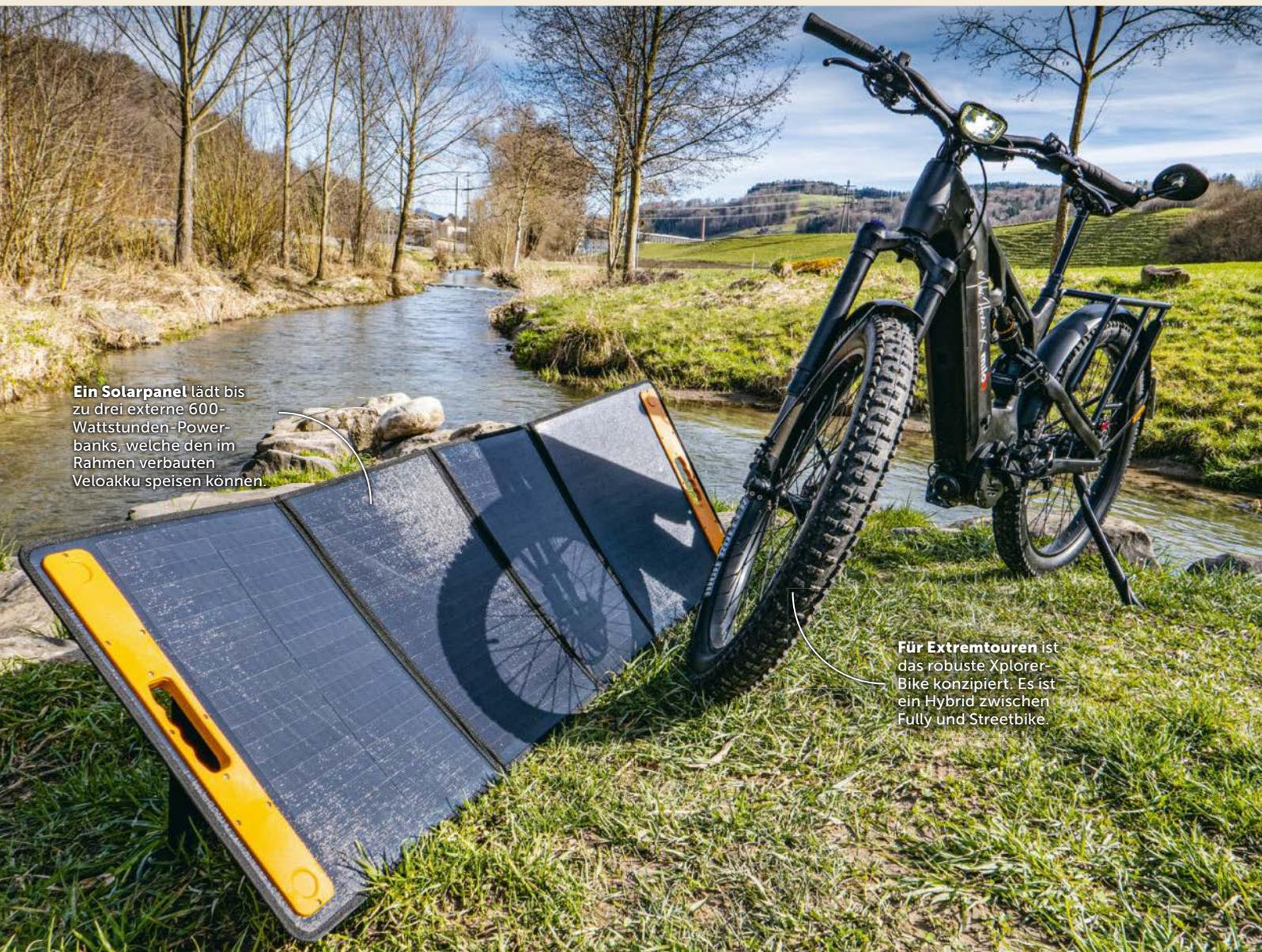
Ein Solarpanel lädt bis zu drei externe 600-Wattstunden-Powerbanks, welche den im Rahmen verbauten Veloakku speisen können.
