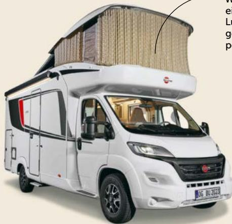
**Aufblas-Alkoven** Die Wände bestehen ähnlich einer Luftmatratze aus Luftkammern. Hinauf gelangt man bequem per Treppe.
