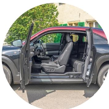
Aufwendige Konstruktion Gegenläufig öffnende Türen.
