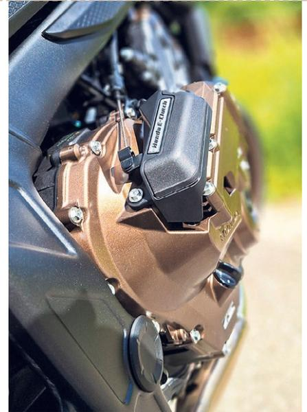
Rechts am Motorgehäuse sind die Komponenten der E-Clutch angeflanscht.
