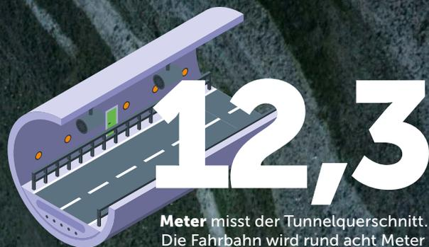
**Meter** misst der Tunnelquerschnitt. Die Fahrbahn wird rund acht Meter breit sein.
