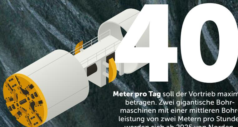
**Meter pro Tag** soll der Vortrieb maximal betragen. Zwei gigantische Bohrmaschinen mit einer mittleren Bohrleistung von zwei Metern pro Stunde werden sich ab 2025 von Norden und Süden durch den Fels bohren.
