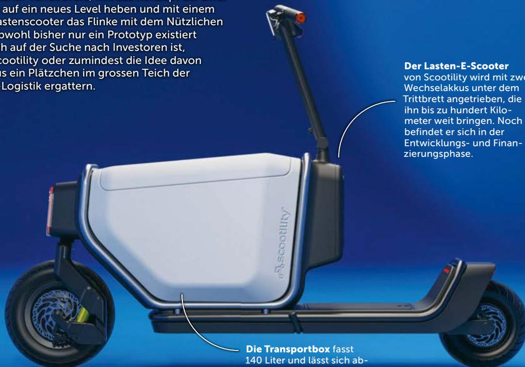
**Der Lasten-E-Scooter** von Scootility wird mit zwei Wechselakkus unter dem Trittbrett angetrieben, die ihn bis zu hundert Kilometer weit bringen. Noch befindet er sich in der Entwicklungs- und Finanzierungsphase.
