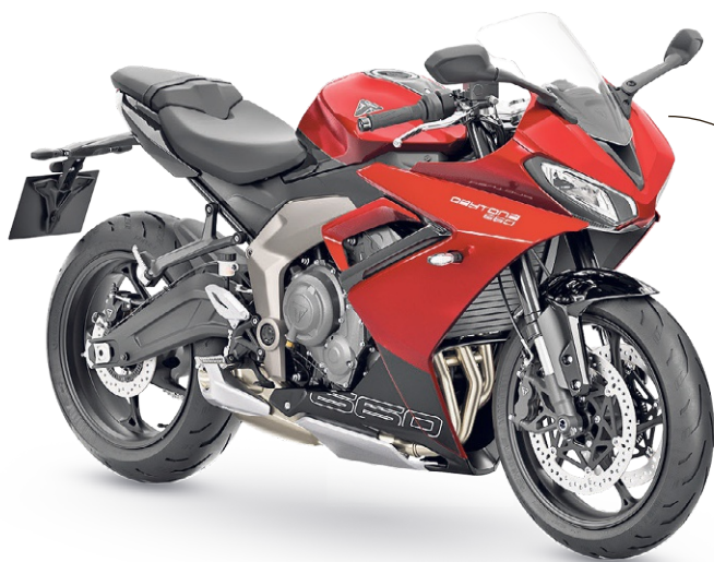
Triumph Daytona 660: moteur trois cylindres, 95 ch et un poids de 201 kg.
