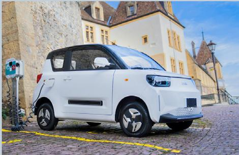
**Silence** aus Spanien baut den extrem kompakten S04. Fährt dank 22 kW starkem Motor 85 km/h. Der Akku lässt sich entnehmen und als Rollkoffer zur Steckdose ziehen.
