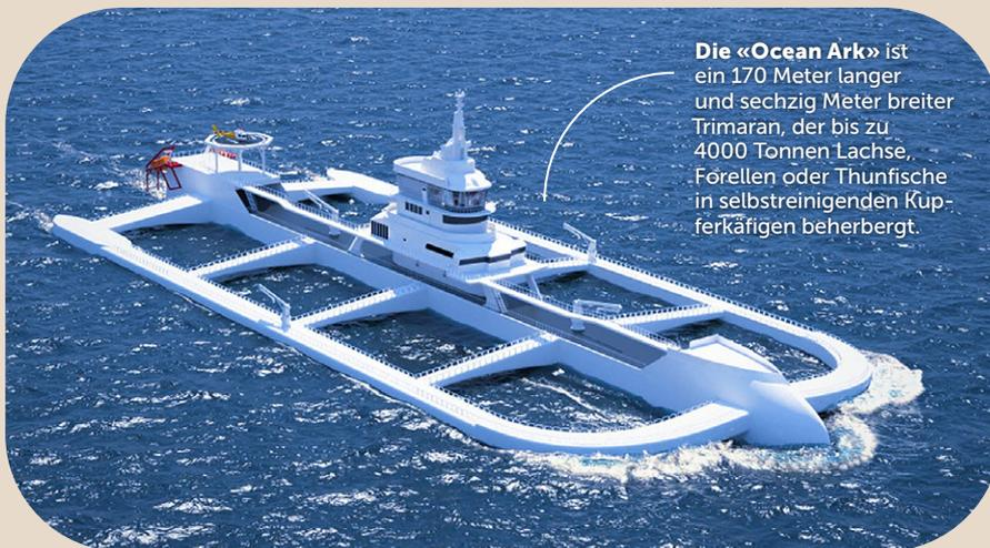
Die «Ocean Ark» ist ein 170 Meter langer und sechzig Meter breiter Trimaran, der bis zu 4000 Tonnen Lachse, Forellen oder Thunfische in selbstreinigenden Kupferkäftigen beherbergt.
