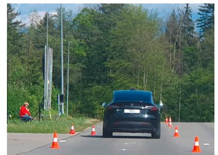
**Auf der Teststrecke** im Stockental erfassten hochempfindliche Mikrofone und Sensoren die Geräusche der Vorbeifahrten.
