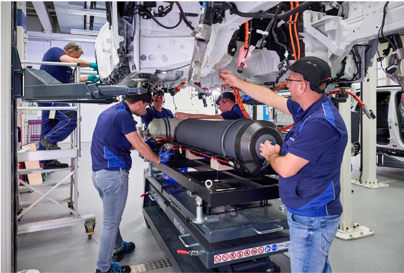
Einbau der Wasserstofftanks für die Kleinserie des BMW iX5 Hydrogen.
