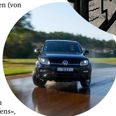
**All-Terrain-Reifen** fallen mit viel Negativprofil auf. Auf Asphalt, besonders im Nassen, stossen sie an Grenzen.
