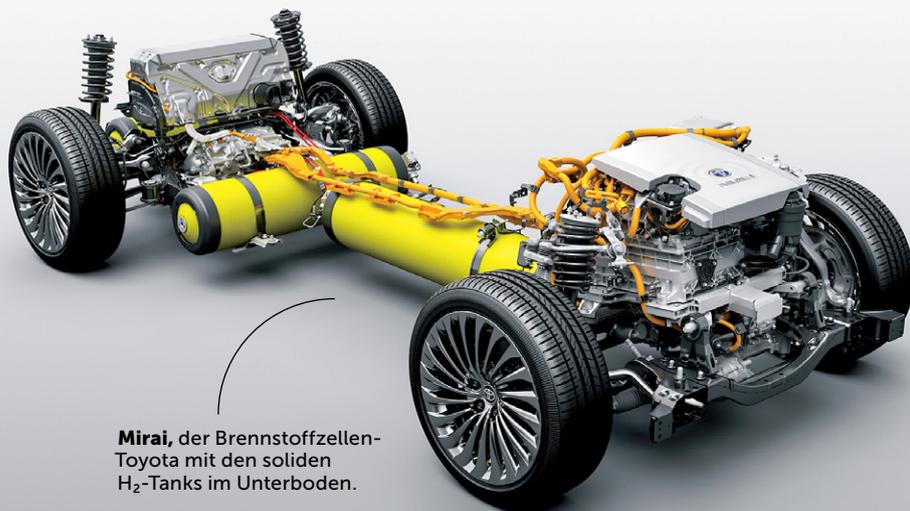
**Mirai**, der Brennstoffzellen-Toyota mit den soliden H<sub>2</sub>-Tanks im Unterboden.
