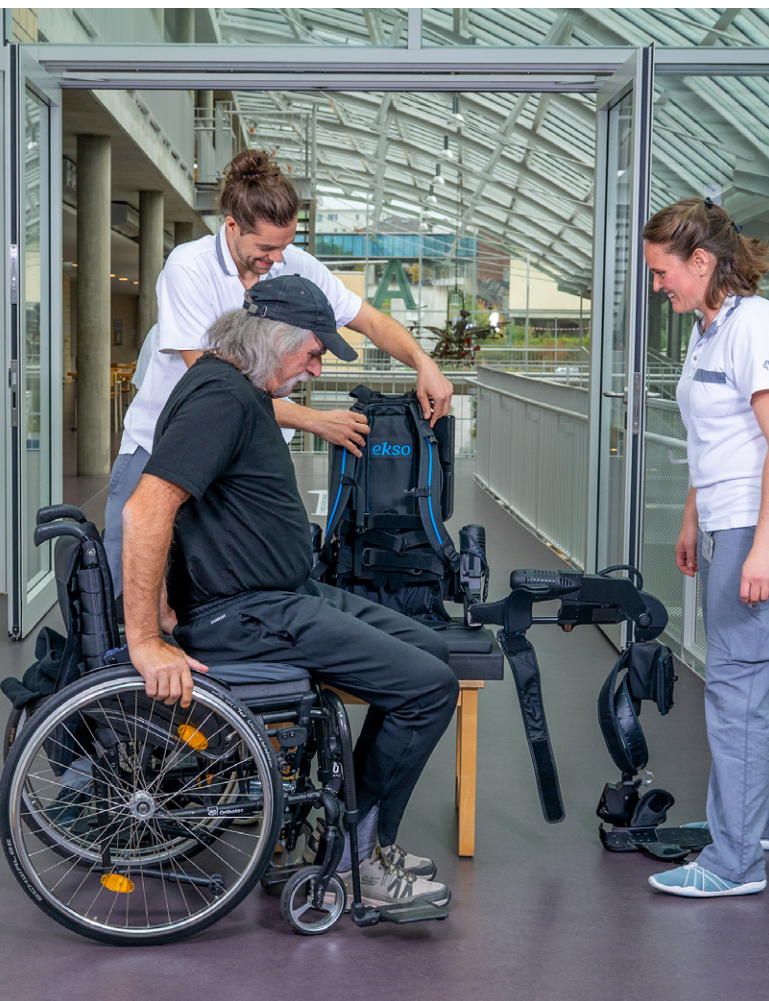
Transfert L'exosquelette EksoNR d'Ekso Bionics ressemble à un sac à dos (en bas), mais certains réglages doivent être effectués avant de l'enfiler.
