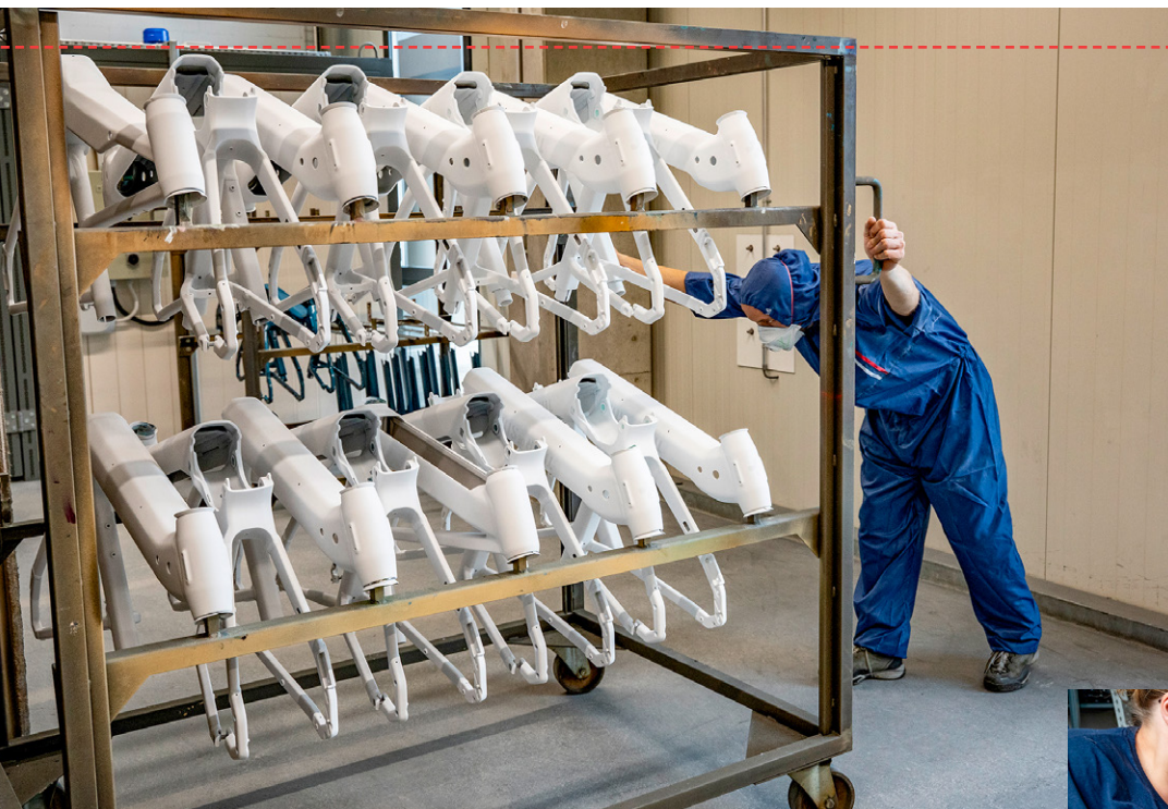
Sind alle Lackschichten aufgetragen, kommen die Rahmen in den Brennofen.
