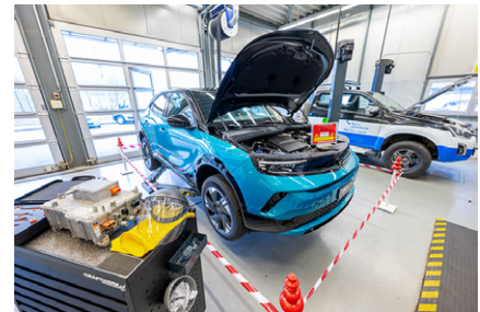
Das Absperrband trennt den Hochvolt-arbeitsplatz vom Rest der Werkstatt ab.
