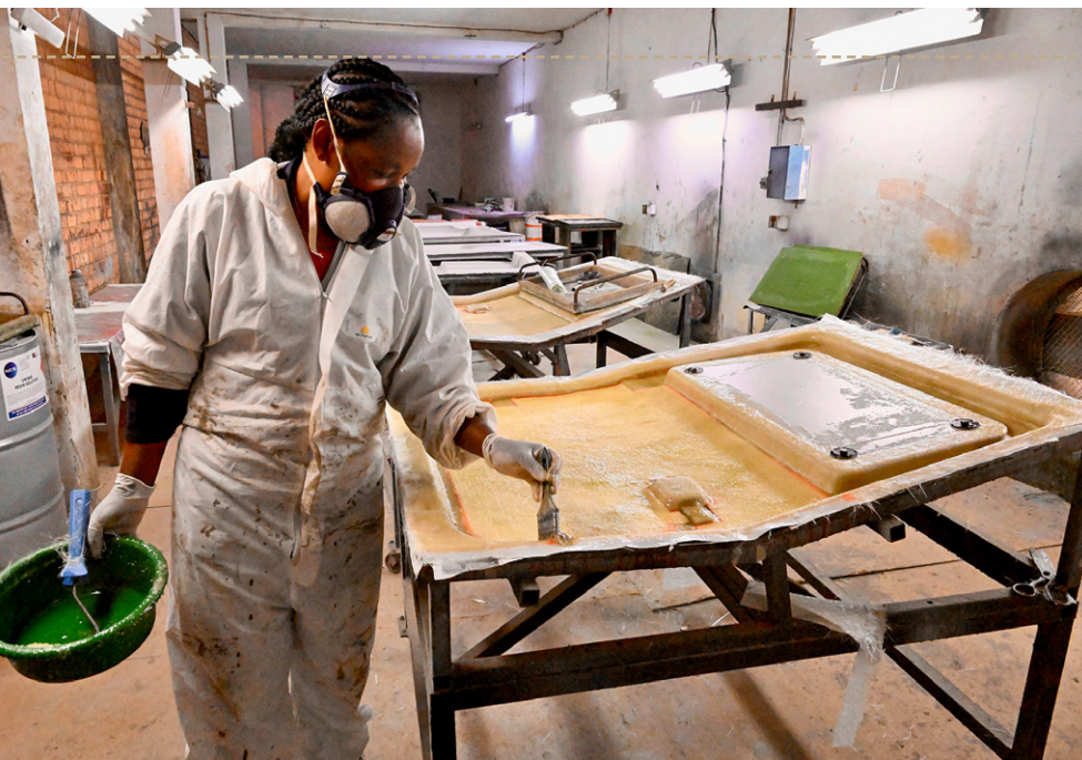
Leichtbau auf Madagaskar: Die Karosserie entsteht aus Fiberglas.
