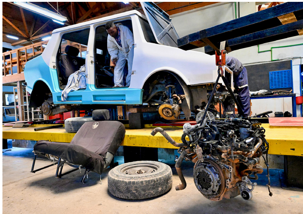
Revision nach 100 000 Kilometern: Eines der ersten Karenjy-Fahrzeuge wird in der Fabrik komplett überholt.
