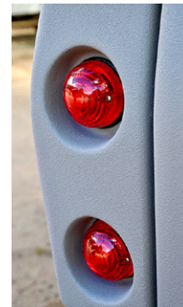
Rücklichter versenkt und so gut geschützt.
