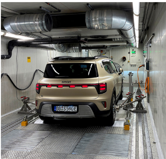
Messfahrten auf dem Rollenprüfstand unter vergleichbaren, klimatisch kontrollierten Bedingungen.
