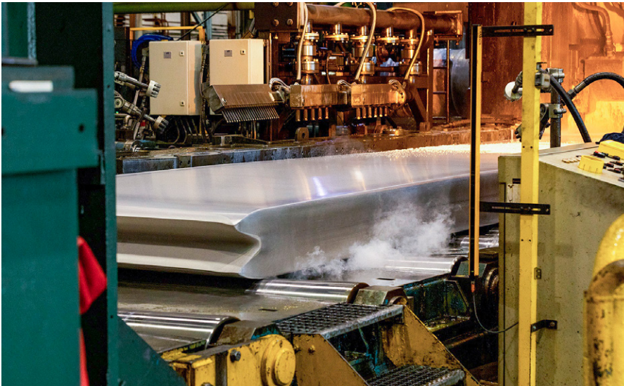
In mehreren Arbeitsschritten werden die Aluminiumbarren zu Blech plattgewalzt.
