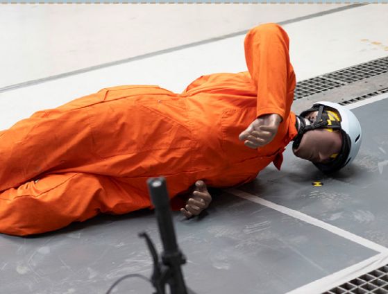
Sensoren am Kopf des Dummys messen die (heftige) Beschleunigung.
