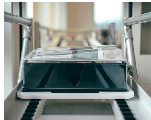
Transport der Einzelteile durch eine Luftschleuse in den Reinraum.
