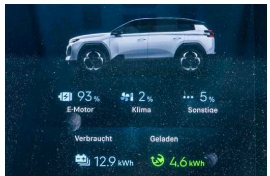
Consommation affichée après une étape partielle: 12,9 kWh consommés, dont 4,6 kWh récupérés.
