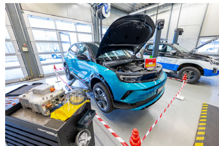
Le ruban de signalisation sépare le poste de travail haute tension du reste de l'atelier.
