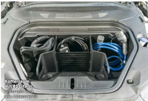
Kofferraum mit 81 Litern, unterteilt und mit Ablassventil
